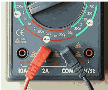
figura 4 - collegamento dei puntali per misure di corrente fino a 2 A.
